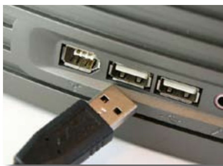
Fig. 17 - Le porte USB a destra e la porta FireWire a sinistra.
