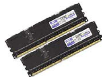
Fig. 8 - Due banchi di RAM con i dissipatori di rame per il raffreddamento.
