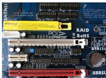
Fig. 13 - Il nuovo slot per le schede video, PCI-E 16X.
