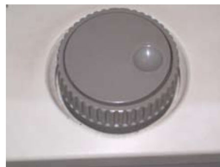
Fig. 9 - Le rotelle Jog e Shuttle, sono concentriche.
