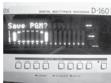
Fig. 10 - Tramite il display del Remote Control, possiamo controllare e configurare le varie funzioni dell'area Setup.
