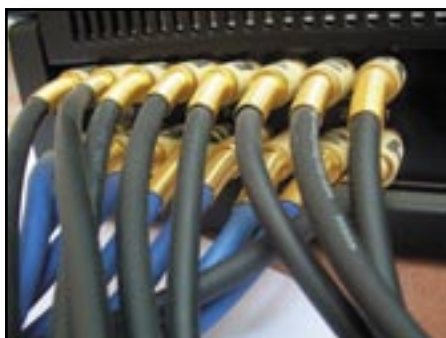
Fig. 20 - Gli ingressi e uscite su connettori di tipo RCA.
