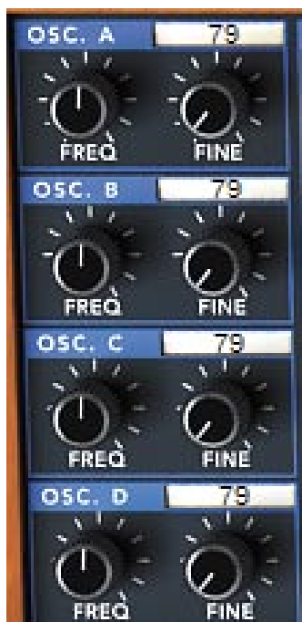
Fig. 5a - I quattro oscillatori A, B, C e D del Prophet VS.
