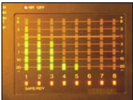
Fig. 27 - I VU meter del registratore, indicheranno dove il segnale è più presente.
