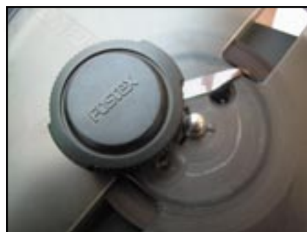
Fig. 16 - Tappo in plastica per fissare qualsiasi tipo di flangia.
