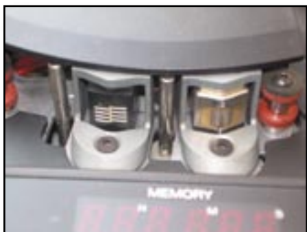
Fig. 12 - Le testine di un registratore analogico, a sinistra quella di cancellazione, a destra quella di registrazione e riproduzione.
