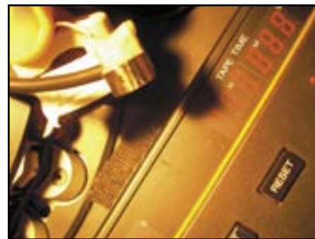
Fig. 25 - Striscia in velcro per fissare la testina al pannello superiore del registratore.
