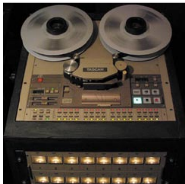
Fig. 1 - Un registratore multitraccia a bobine Tascam.
