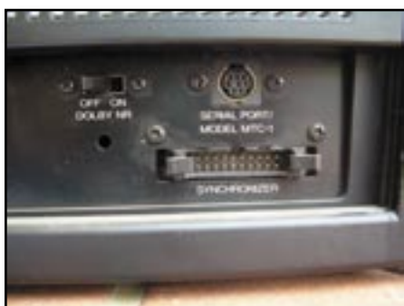
Fig. 19 - L'interruttore di Noise Reduction e i controlli per la sincronizzazione di dispositivi esterni.
