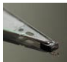
Figura 2 - La testina di un hard disk.
