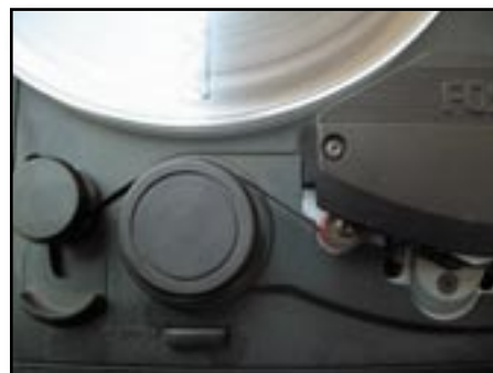
Fig. 17 - Le varie rotelle che consentono il passaggio del nastro.
