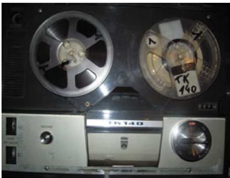
Fig. 3 - Un Grundig TK-140 valvolare a 2 tracce, degli anni '50.
