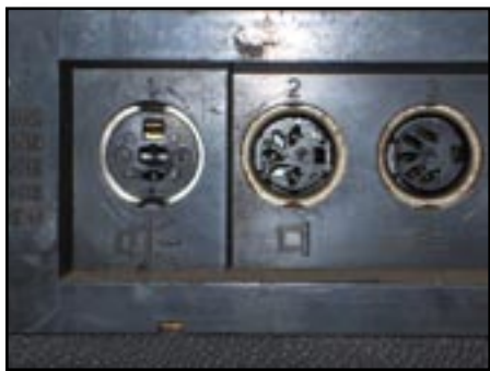
Fig. 9 - I vari attacchi allocati sul pannello posteriore. Più a sinistra, la connessione per un altoparlante esterno.
