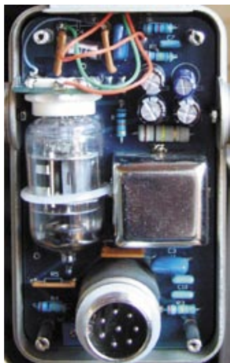
Figura 4 - All'interno dell'Helios si trova il circuito di preamplificazione pilotato da una 12AX7B.
