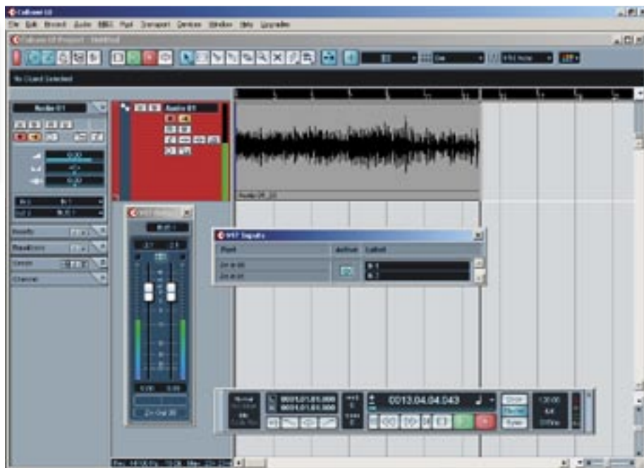
Figura 8 - Cubase LE configurato con i bus di ingresso e uscita per lo Zoom H4.
