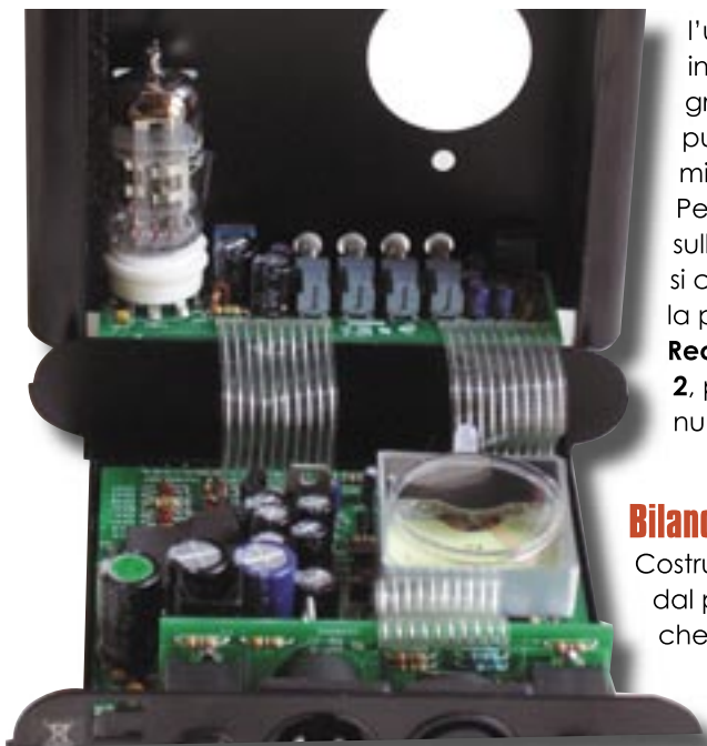
Fig. 1 - La valvola 12AX7a all'interno del Tube NP Studio.
