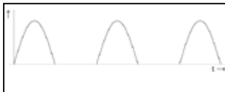
Fig. 3 - Con un diodo polarizzato anodo-catodo passa solo la "mezza onda" positiva.
