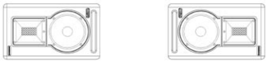
Fig. 5 - Posizionamento orizzontale dei monitor con i woofer verso il centro per rinforzare i bassi.
