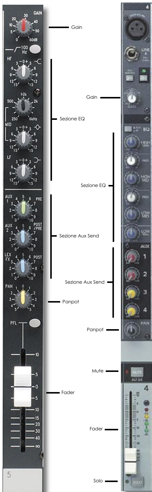
Fig. 2 - Due esempi di Channel Strip: i controlli sono pressoché gli stessi.
