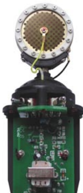
Fig. 6 - Il diaframma vaporizzato d'oro.
