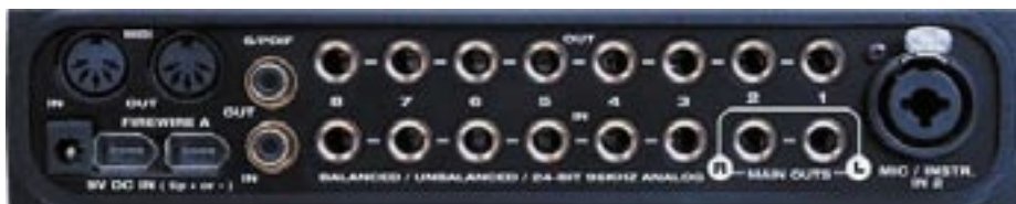
Fig. 2 - Le connessioni sul retro della MOTU Ultralite.
