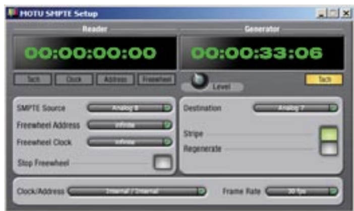
Fig. 4 - Il software per la lettura e la generazione del timecode SMPTE.
