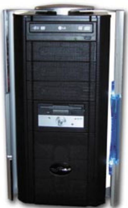
Fig. 11 - Il case si apre sulla parte frontale facendo ruotare i due pannelli di protezione.
