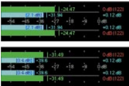
Fig. 3 - Sopra il livello di rumore con ventole accese, sotto, con ventole spente.
